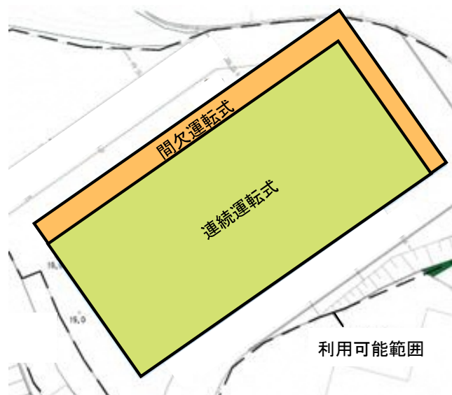
図 3-2 炉型式による施設寸法と配置
